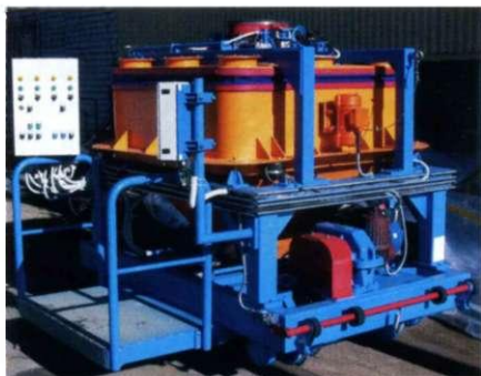
Электровесовая тележка новой конструкции
